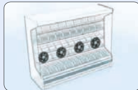
Der er begrænset plads til montering af blæsere i bagvæggen af køle- og fryseskabe.
