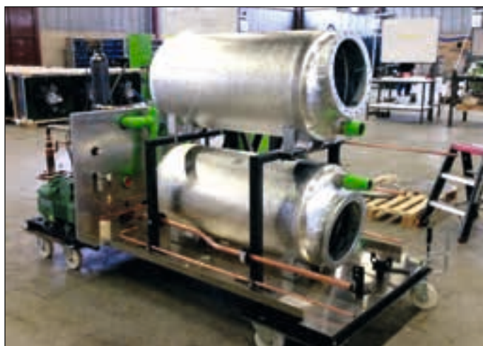
Tankene for lagring av PCM-materialet (fase endringsmateriale salter).
